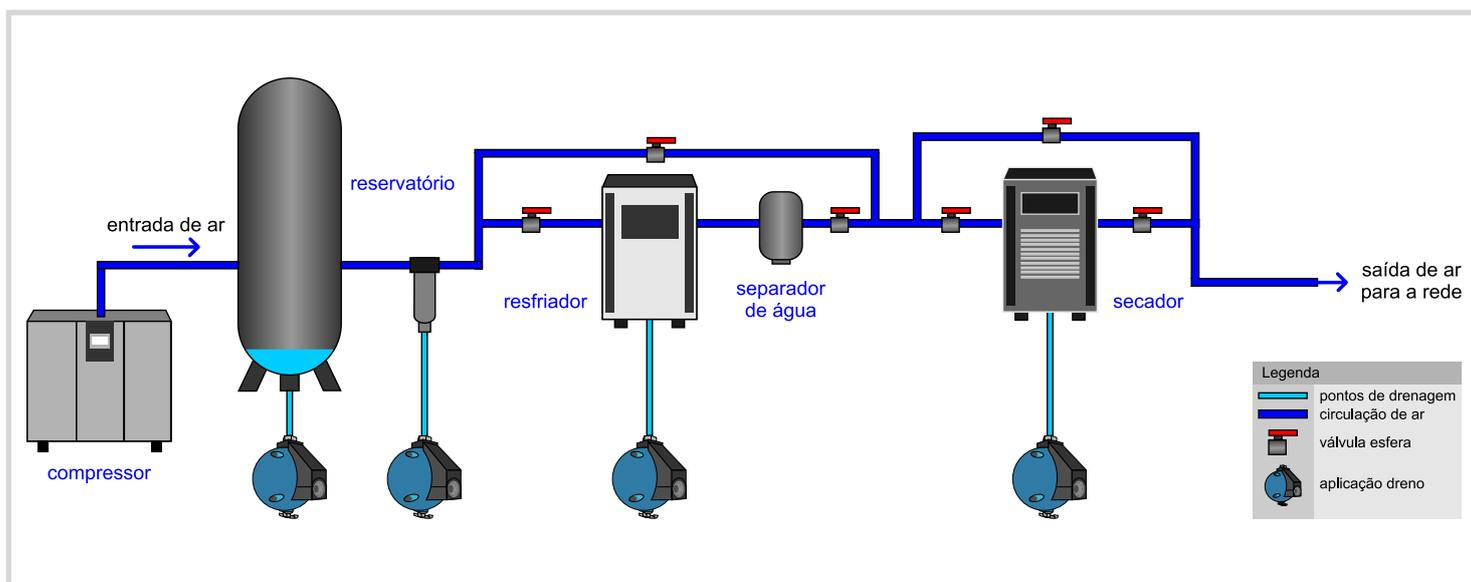
O dreno esférico deve ser instalado no ponto mais baixo, onde ocorra escoamento do condensado. No ponto de saída do dreno, recomenda-se a instalação de uma mangueira ou tubulação que encaminhe a água drenada para um sistema de tratamento (pois há óleo na água do sistema de ar).
